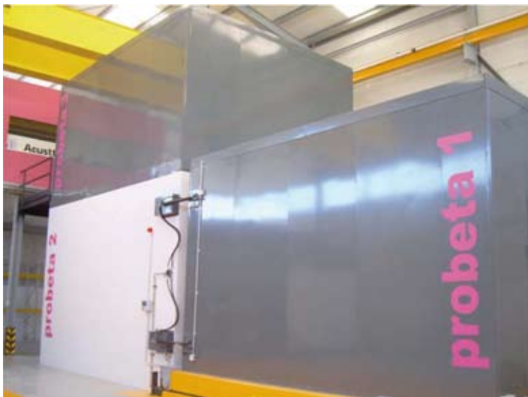
Fotografía 1. Vista general de cámaras de ensayo normalizadas de Acusttel
