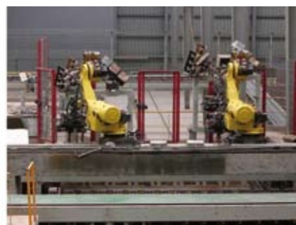
Producción de adoquín cerámico automatizado. Estabilidad dimensional y resistencia al desgaste del color
